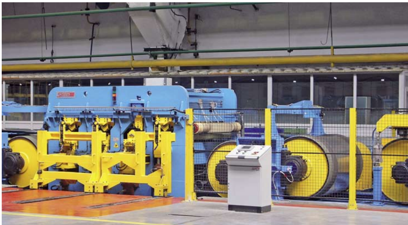
Abb. 9: Typische Streckrichtanlage von Salico
