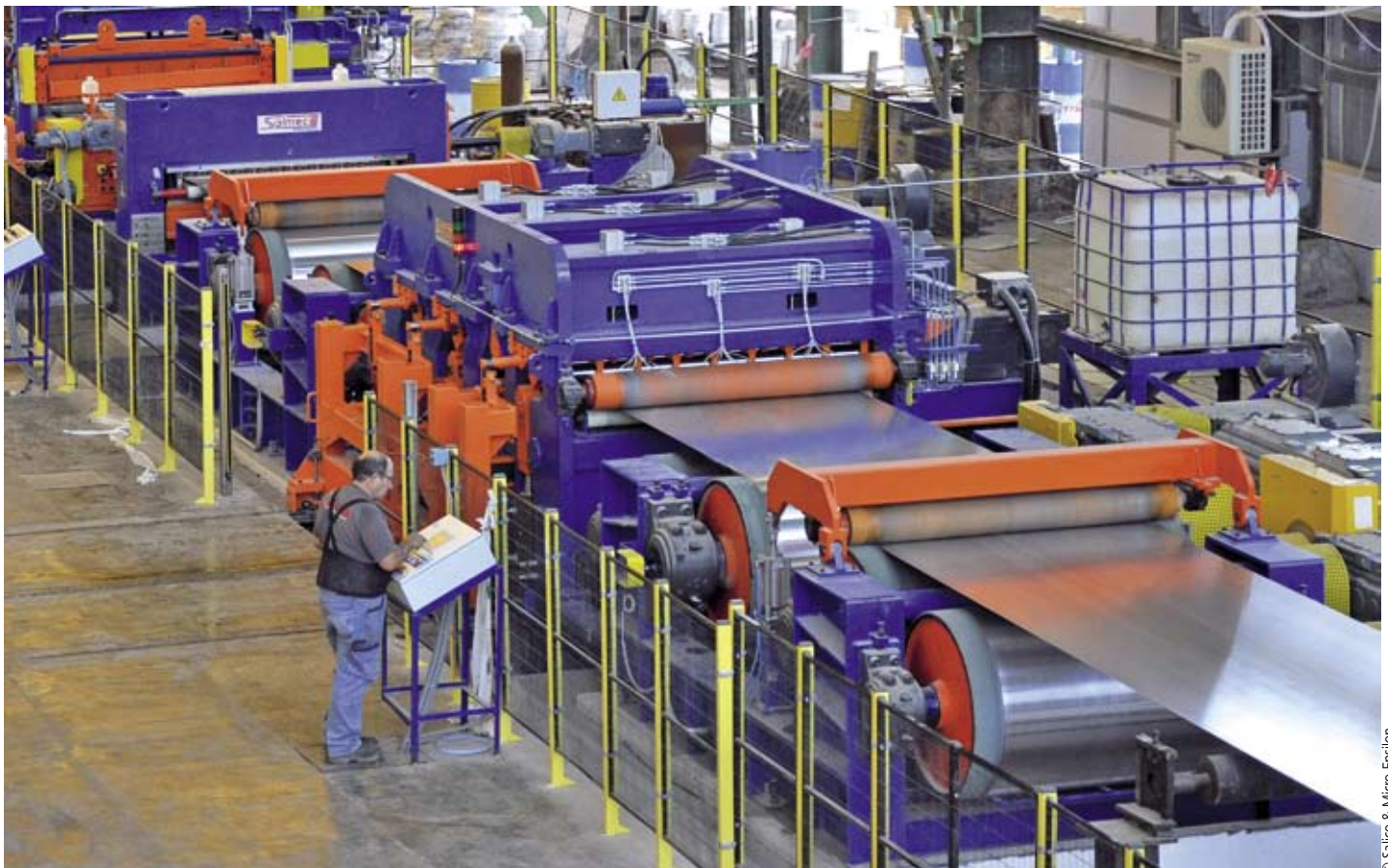
Abb. 1: Streck-Biege-Richtanlage von Salico
