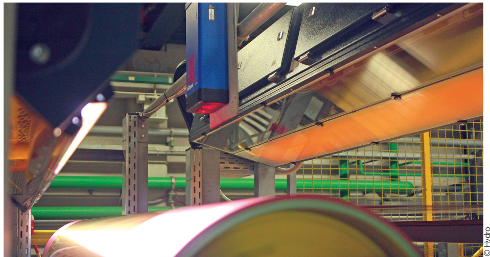
Abb. 2 Bandlängenerfassung im Zuge einer Oberflächeninspektion
