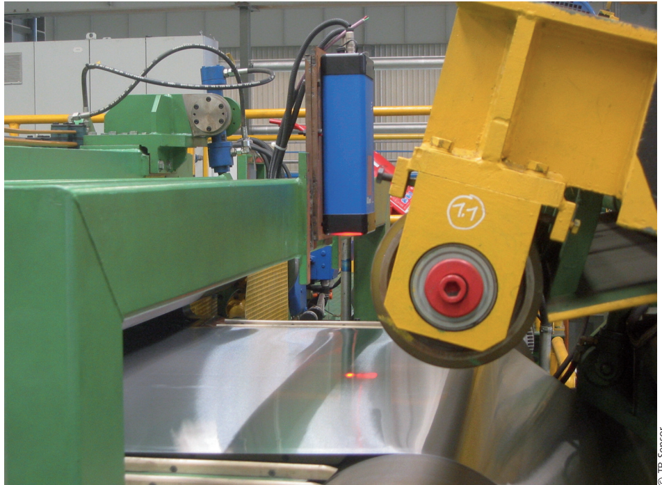
Abb. 1 ASCOSpeed in einer Danielli-Bandanlage
