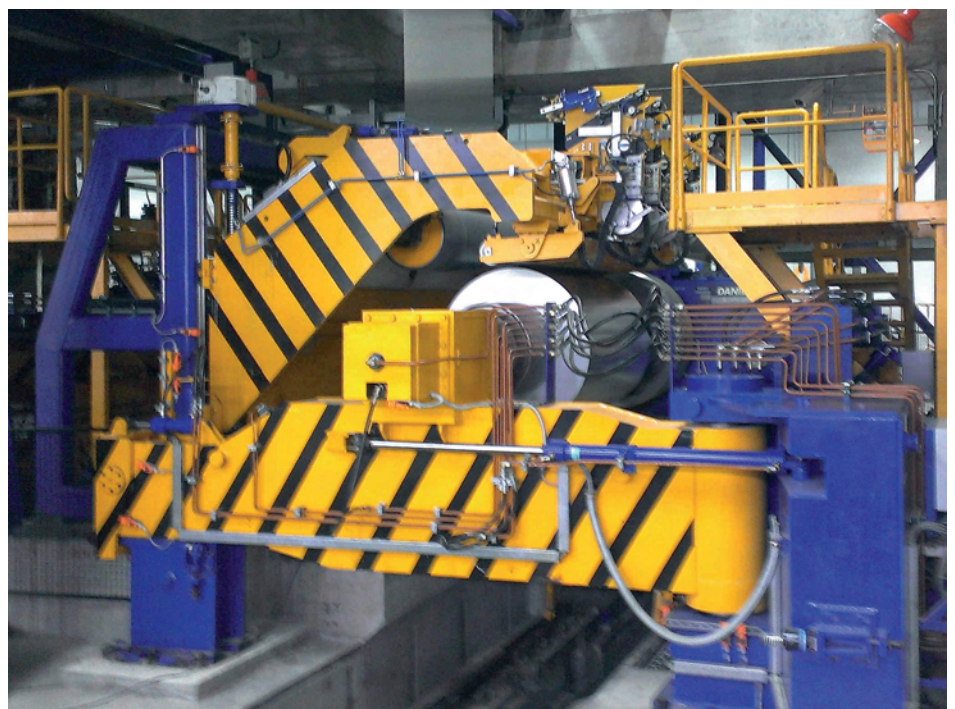
Abb. 3: Auslaufführung mit automatischen Klebeköpfen
