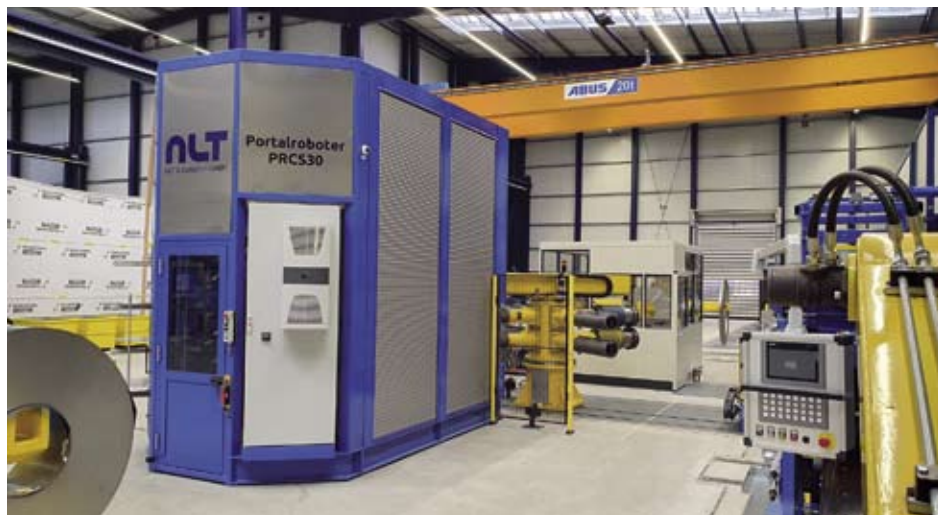
Abb. 5: Portalroboter PRCS30 im Zuge der Gesamtanlage
