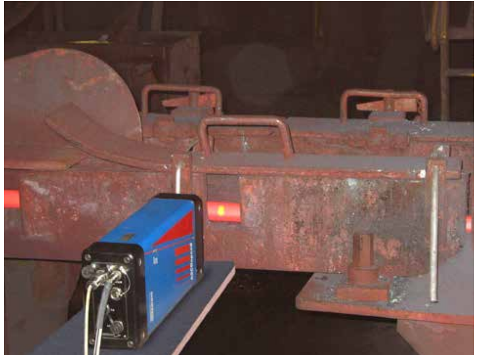
Bild 1: Geschwindigkeitsmessung am Einlauf einer Profilwalzstraße. Alle Fotos Quelle © TB Sensor GmbH
