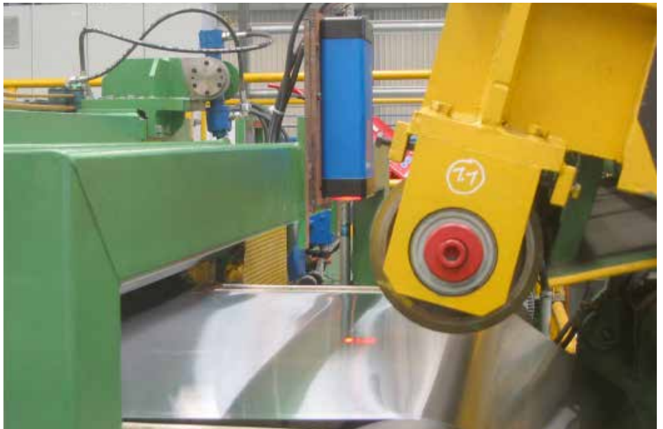
Bild 4 Geschwindigkeitsmaster in einer Schneidanlage Foto Quelle © TB Sensor / Sensmation China
