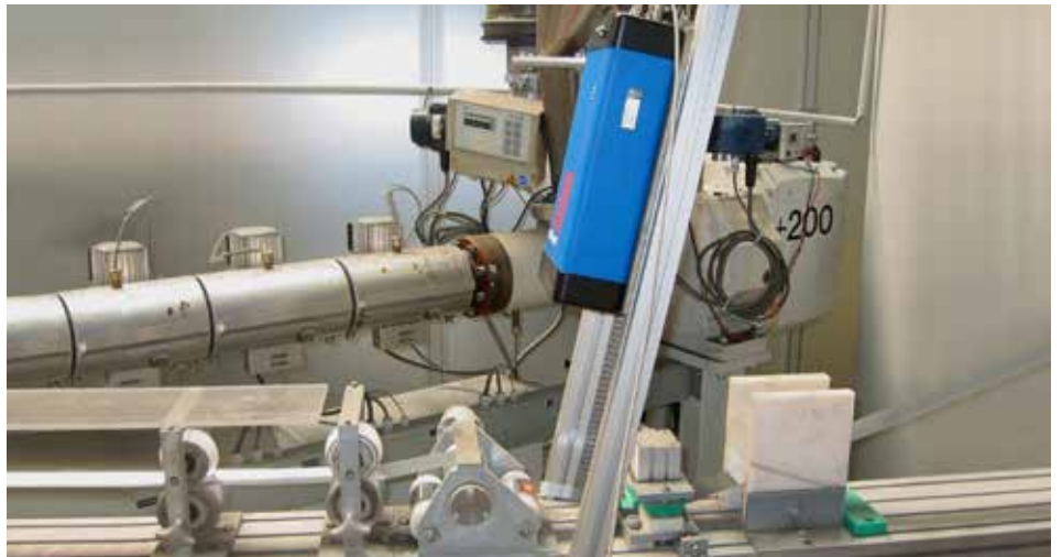
Bild 5 ASCOSpeed in Rohreinförmigkeit
