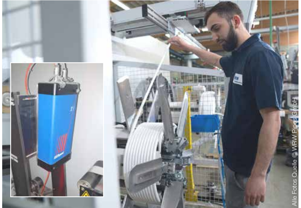
Bild 1 Produktionslinie Mehrschichtverbundrohr bei WRW Pipes GmbH mit ASCOSpeed
